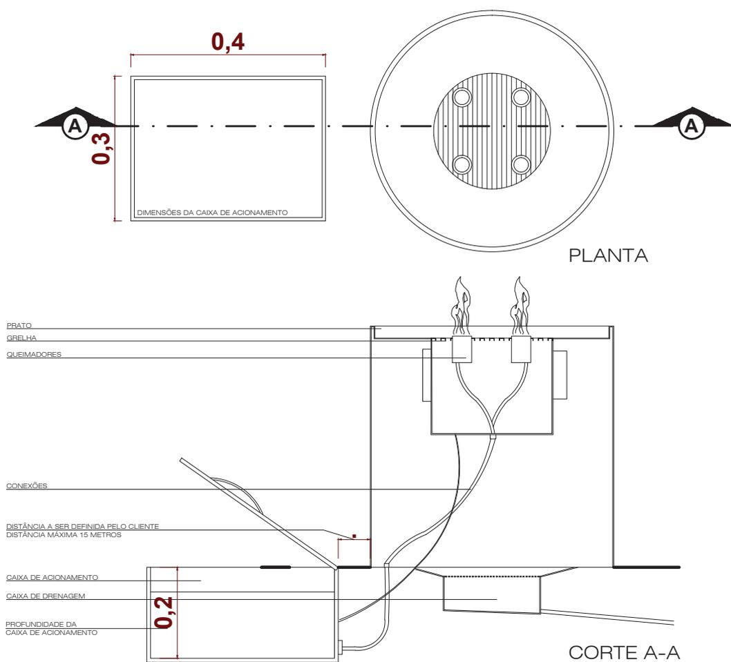
\* NOTA - A CAIXA DE DRENAGEM DEVE SER LIGADA NA REDE DE ESCOAMENTO D'ÁGUA.
